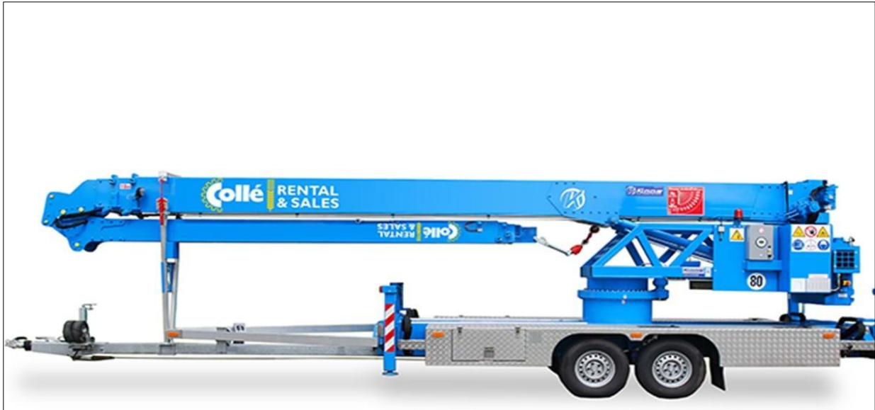
Voorbeeld van een lichte, mobiele kraan. Geschikt voor het aanreiken van o.a. dakpannen, dakleer isolatiemateriaal, glas en kozijnen.
